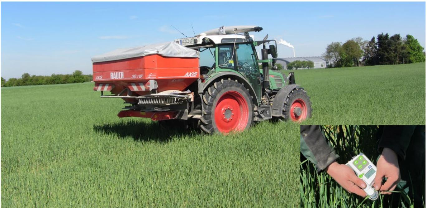
N-Sensor mit Düngemittelstreuer und N-Tester zum Kalibrieren des Sensors
